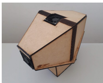
Figura 2: Protótipo da armadilha seletiva para mosquitos baseada em sucção e exaustão
