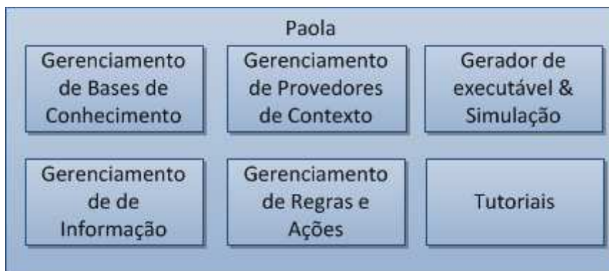
Figura 18 – Diagrama de blocos dos módulos da plataforma Paola
